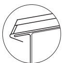
Ukončení okapnice, stojaté šikmé
