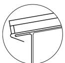
Ukončení okapnice, stojaté kolmé (pouze pro opticky nenáročné oblasti použití)
