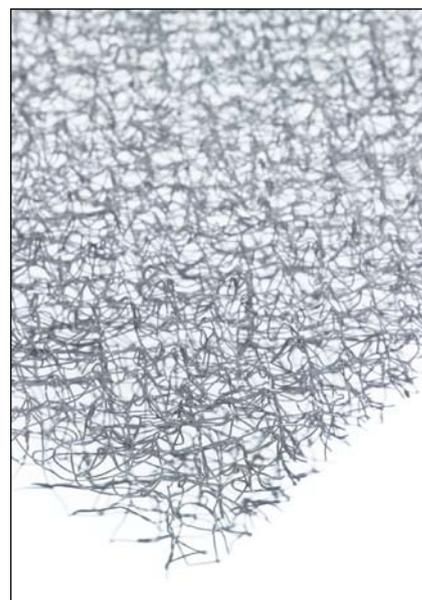
AIR-Z viene posata su strati separatori di grande formato (per esempio bituminosi) con sottostrutture in tavolato o pannelli in legno (per es. OSB). Il campo di impiego principale sono le coperture metalliche con una pendenza da 3° a 15° nonché tutte le coperture con strato di supporto formato da pannelli in legno
