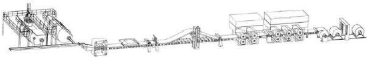
Рис. 12: Непрерывный процесс изготовления цинковых рулонов на широкоформатной литейно-прокатной линии РАЙНЦИНК
