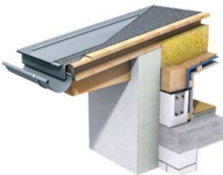
Bild 1: Ventilerad takkonstruktion med isolering mellan takstolarna.
