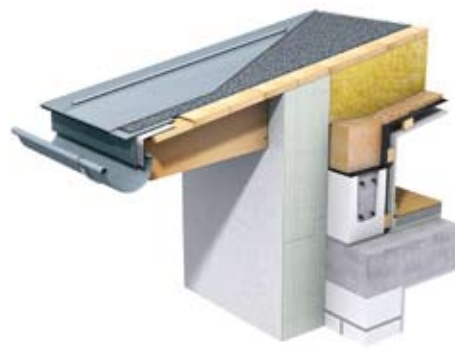
Bild 2: Oventilerad takkonstruktion med helisolerade sparrar
